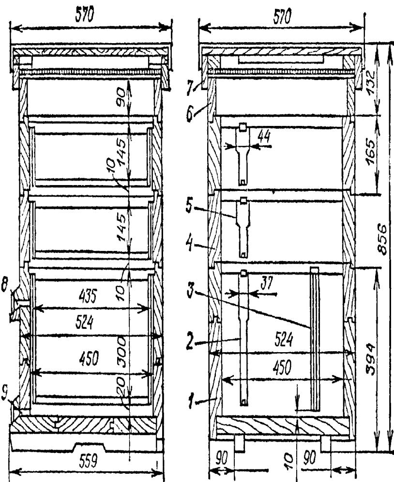
Рис. 32. Устройство двенадцатирамочного улья с двумя магазинами (разрез
